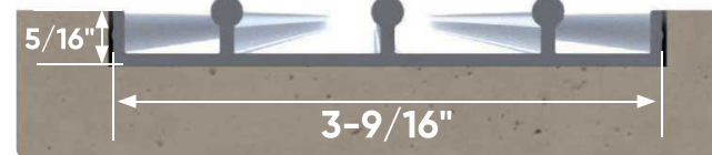
Installing the MINI bottom guide profile in the floor
